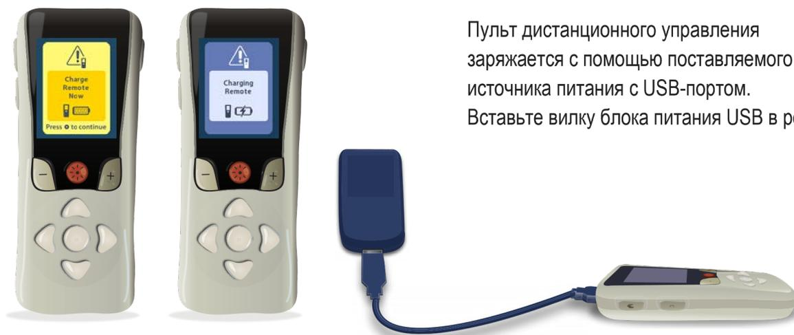
Пульт дистанционного управления заряжается с помощью поставляемого источника питания с USB-портом. Вставьте вилку блока питания USB в розетку.
